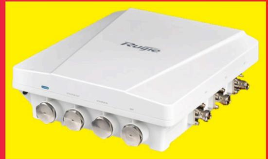
Ruijie RG-AP630 представляет собой высококлассную внешнюю точку доступа стандарта 802.11ac следующего поколения высокоскоростных беспроводных сетей, предлагающих скорость доступа до 1.75Гб/с. ТД RG-AP630 включает все важные элементы, как беспроводная безопасность, управления частотами, мобильный доступ, качество обслуживания, бесшовный роуминг и пр. Вместе с серией беспроводных ТД Ruijie RG-WS, ТД предлагает беспроводную пересылку данных пользователя, повышенную безопасность и контроль доступа.
